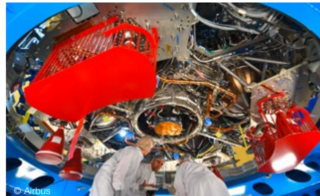
Das Servicemodul sorgt für Antrieb, Klimatisierung und Versorgung des Orion-Raumschiffs.
