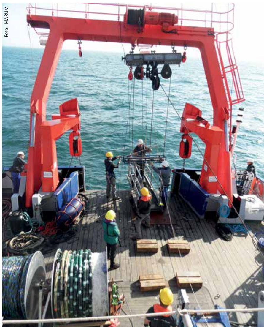
Wissenschaftler und Techniker beim Ausbringen des Geotechnical Offshore Seabed Tools (GOST). Bei der Messung wird eine Lanze mit Sensoren an der Spitze in das Sediment gedrückt. Dabei werden kontinuierlich Messwerte aufgezeichnet, aus denen sich dann Informationen über Bodenfestigkeit und Sedimenteigenschaft ableiten lassen. Scientists and technicians during the laying of Geotechnical Offshore Seabed Tools (GOST). A lance with sensors attached to its tip is lowered into the sediment to take measurements. This technique makes it possible to take continual measurements and gain information on the firmness of the seabed and sediment characteristics.
