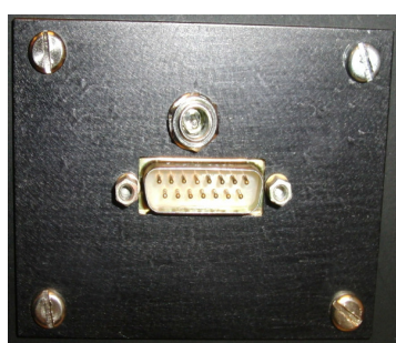
Abb. 11: Steckerleiste: Stromversorgung Schrittmotor und Anschluss der seriellen Schnittstelle.
