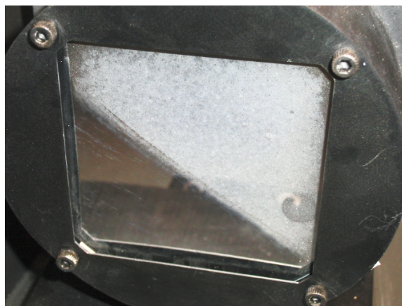
Abb. 26: Ursprungszustand der Spiegel vor der Reinigung mit Aceton (oberes Dreieck)
